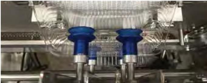
El equipamiento de Inline se ha diseñado para tomar los contenedores vacíos y colocarlos en un transportador de embalaje de forma rápida, precisa y eficiente.
