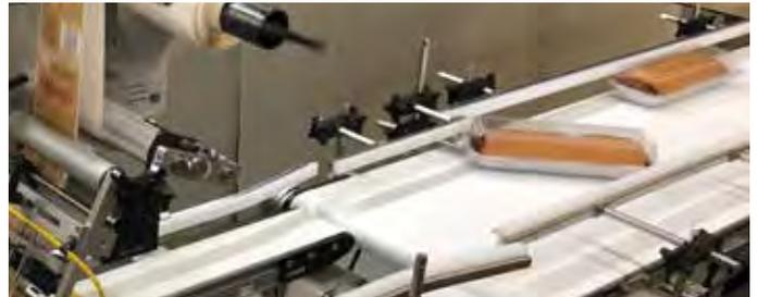
Podemos automatizar la vibración de los contenedores para asentar la comida, voltear el contenedor sobre su tapa o girarlos a la posición deseada para etiquetarlos o marcarlos por chorro de tinta.
