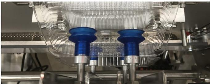
Este equipo se ha diseñado para tomar los contenedores vacíos y colocarlos en un transportador de embalaje de forma rápida, precisa y eficiente.
